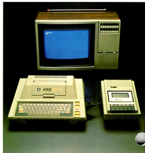
**4** Den Fernseher und den Computer einschalten. Der Fernsehbildschirm zeigt die Bedienungsführung READY (BEREIT) an.
