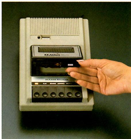
**2** Eine leere Kassette in den Programm-Recorder einlegen.
