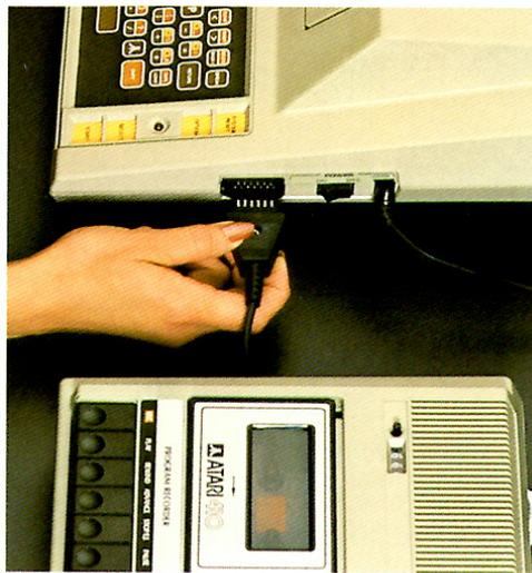
**1** Das Datenkabel des ATARI 410 Programm-Recorders in die mit PERIPHERAL (Peripheriegerät) bezeichnete Buchse an der rechten Seite des ATARI Privat-Computers stecken.
