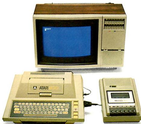
**3** Zuerst den Fernseher, dann den Computer einschalten. Auf dem Fernsehbildschirm wird die Bedienungsführung READY (BEREIT) angezeigt.
