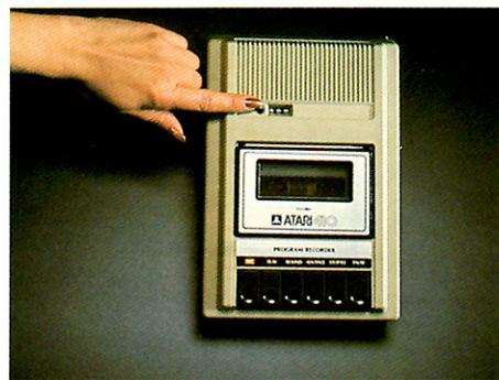
**5** Den Zähler auf 000 stellen. Wird auf dieser Seite der Kassette nur ein Programm sichergestellt, so ist das Gerät jetzt aufzeichnungsbereit. Befinden sich schon andere Programme auf dieser Seite, wird mit Schritt 6 fortgefahren.
