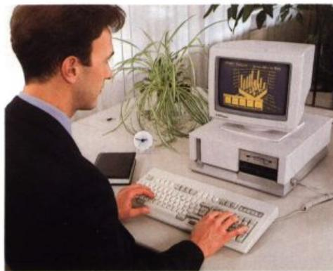
Serienmäßig arbeitet der PC4 im VGA-Modus. Mit dem passenden Monitor nutzen Sie so das volle Leistungsangebot in Farbe. Sie können aber auch andere Monitore anschließen, um im hochauflösenden MDA- und im Hercules-Modus mit 720 x 348 Bildpunkten, im EGA-Modus mit 640 x 350 Punkten und im CGA-Modus mit 640 x 200 Punkten zu arbeiten.
