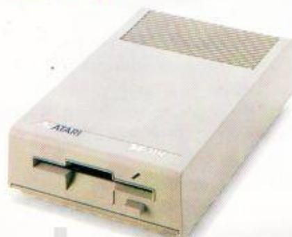
3,5 Zoll Diskettenstation mit zwei Schreib-/Leseköpfen und einer Schreibkapazität von 720 kBytes formatiert. Pro Sekunde werden 250 kBit gelesen und geschrieben. Der Anschluß erfolgt über die serielle ATARI-Schnittstelle.
